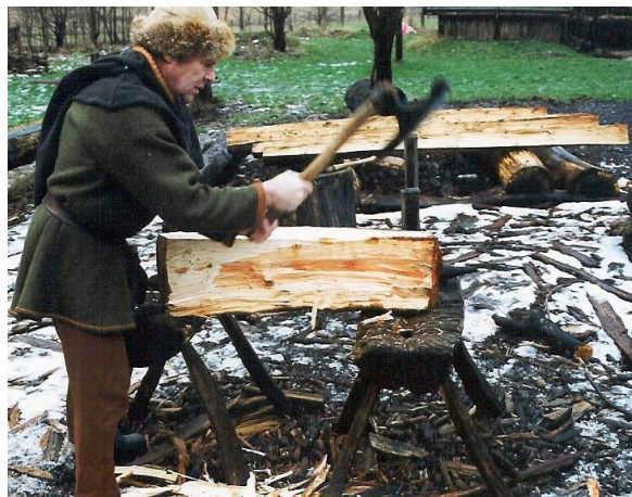
Efter at stammen er blevet flækket, bliver den ene halvdel med en bred økse hugget plan på kernesiden. Instrumentets form optegnes for derefter at bliver groft tilvirket med økse.
