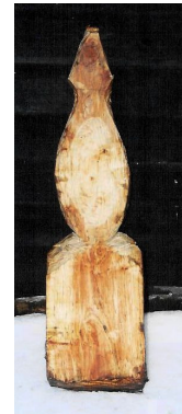
Efter at stammen er blevet flækket, bliver den ene halvdel med en bred økse hugget plan på kernesiden. Instrumentets form optegnes for derefter at bliver groft tilvirket med økse.
