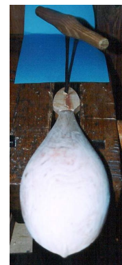
Instrumentets krop (korpus) formes og udhules med huljern- stemmejern og båndkniv. Med et ske bor laves de tre huller til stemmeskruerne.
