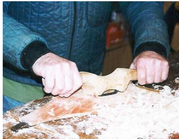
Med en båndkniv høvles klangbrættet tyndere
