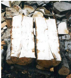
Efter at stammen er blevet flækket, bliver den ene halvdel med en bred økse hugget plan på kernesiden. Instrumentets form optegnes for derefter at bliver groft tilvirket med økse.
