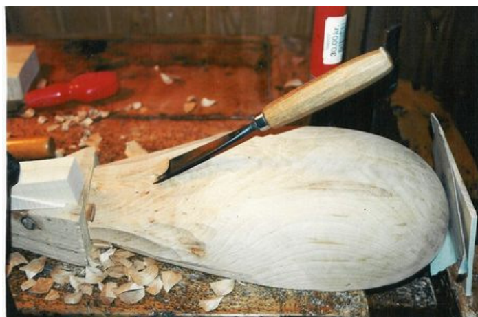
Instrumentets krop (korpus) formes og udhules med huljern- stemmejern og båndkniv. Med et ske bor laves de tre huller til stemmeskruerne.
