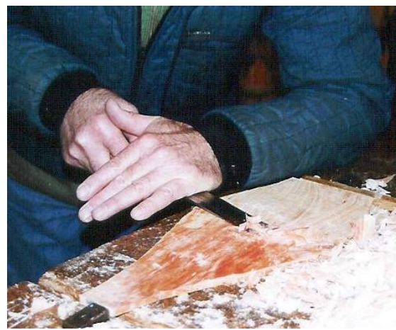
Med en båndkniv høvles klangbrættet tyndere
