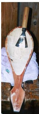
Instrumentets krop (korpus) formes og udhules med huljern- stemmejern og båndkniv. Med et ske bor laves de tre huller til stemmeskruerne.
